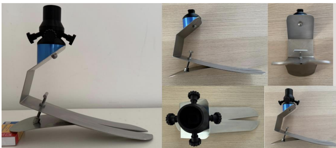
Afbeelding 1: De prototype prothesevoet met vaststellingssysteem
