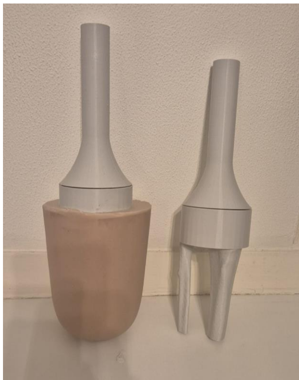
Afbeelding 1: De uitgeharde dummystomp en het ge-3D-printe botstuk
