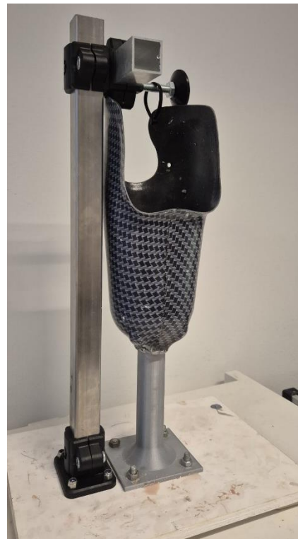
Afbeelding 2: De prothesekoker waar de siliconen in gegoten worden. Naast de prothesekoker een houder om het botstuk op zijn plek te houden.
